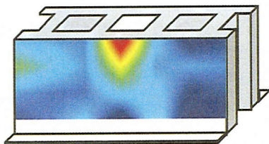
図-15 同定された振動モード形 (4700Hz)
